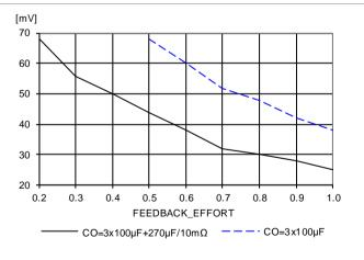
V<sub>I</sub>=12 V, V<sub>O</sub>=1.2 V, load step 3-9-3 A,1 A/us.
