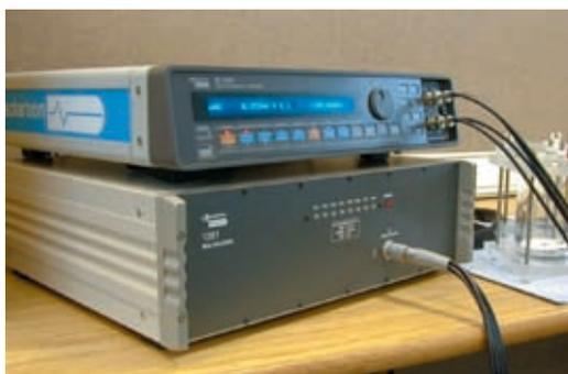
1281 型为电脑控制型 8 通道扫描仪,通过与 Solartron 公司生产的恒电位 / 恒电流仪、电化学测定装置等连接可自动测定多个样本。
