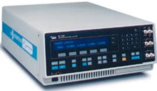
Solartron 公司的 1260 型的频率范围在  $10\ \mu\text{Hz} \sim 32\text{MHz}$ ，利用此阻抗分析仪，在一台仪器上就能完成对阻抗、增益、相位、群组、延时等分析。该设备的精确度达到 0.1%，可测定频率、振幅、或偏差中的某一被选定点，也可进行多定点的测定，还可在自动扫描中进行测定，是一台高操作性的分析仪。
